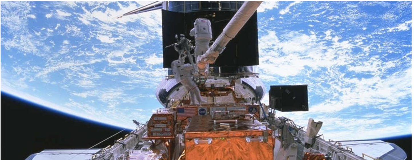
Imagen: Los astronautas Smith y Lee instalan el STIS durante la segunda misión de mantenimiento del Telescopio espacial Hubble
